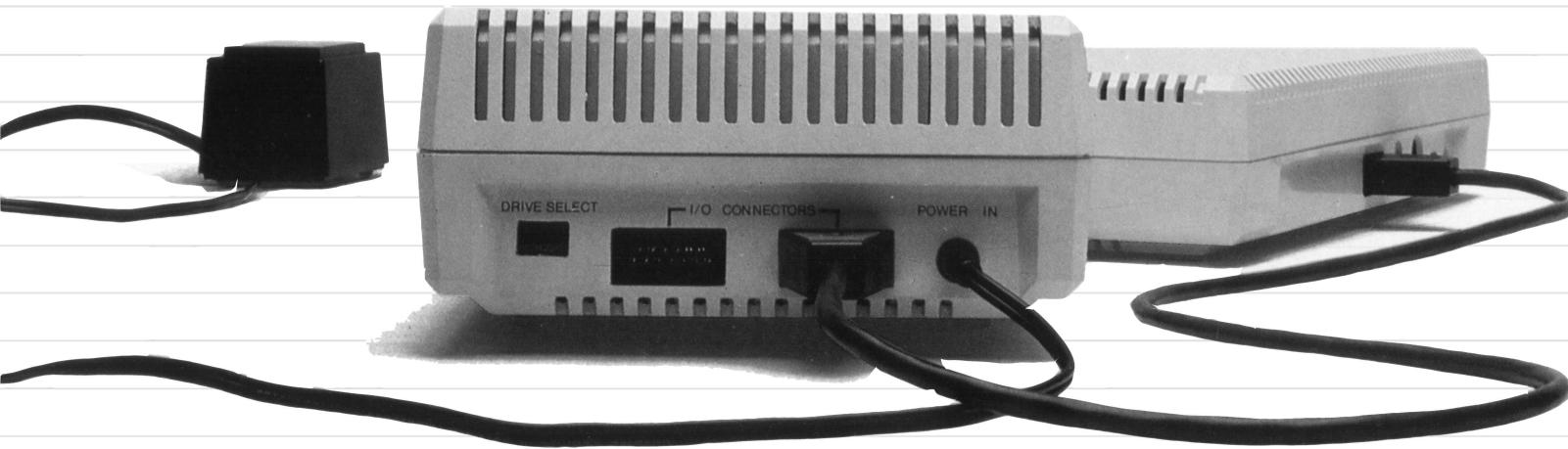
Bis zu vier Diskettenstationen können, zusätzlich zu anderen Geräten, an das ATARI Computer-System angeschlossen werden. Alle Stationen werden per Datenkabel und entsprechend den obigen Hinweisen untereinander verbunden. Damit der ATARI Computer alle Stationen erkennen und unterscheiden kann, sind sie durch
