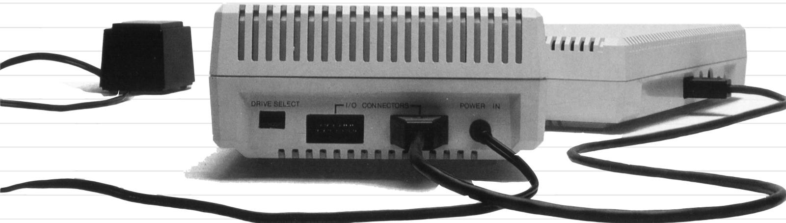
All'ATARI Home Computer si possono collegare, oltre ad altri componenti, fino a quattro unità a disco ATARI 1050, tramite i cavi seriali di entrata/uscita (I/O) che vengono forniti a corredo di ogni unità.
