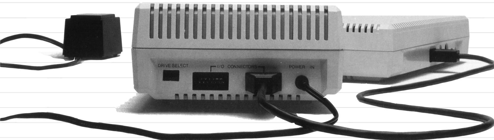
Maximaal kunnen vier diskettestationnen, aangesloten worden op de ATARI huiscomputer door middel van data I/O-kabels die bij de randapparaten geleverd worden. Om verschillende diskettestationnen te installeren moet men een kabel-aansluiting leggen tussen de I/O CONNECTOR op het eerste diskettestation en een PERIPHERAL-aansluiting op de computer. Verbind de andere I/O CONNECTOR op het eerste diskettestation met één van de I/O CONNECTOR aansluitingen op het tweede diskettestation.
