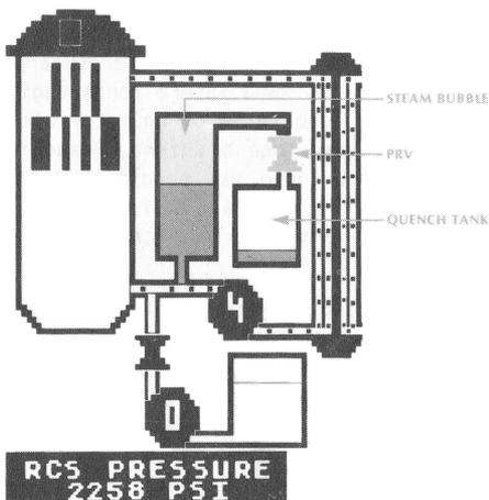
Fig. 5 - Il pressurizzatore.
