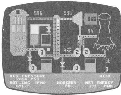
Fig. 13b - Conduttività termica bassa nell'RCS - Aumento temperatura.
