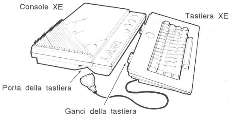
Il retro della tastiera ha ampie prese per il collegamento alla console. Per collegare le due unità, allacciate il fronte della tastiera con la console attraverso i due ganci di plastica.
